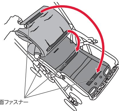
③ シート側面およびヘッドレスト部の面ファスナー(左右)をとめながらシートをかぶせる。
