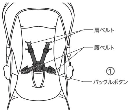
② シート背面の止めバックル(4つ)を、ベルト通し穴から前側に出し肩ベルト、腰ベルトをシートからはずす。
