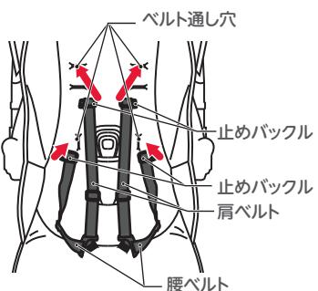
⑥ ベルトが抜けないよう、シート背側、底面(座席裏側)の止めバックルの向きを図の向きに整える。
