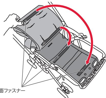
③ シート側面およびヘッドレスト部の面ファスナー(左右)をとめながらシートをかぶせる。
