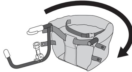
④ 座面手前にあるボタンを外し、座面ボードを抜き取ります。
